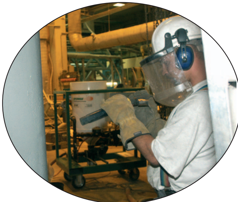
Rikoschetterna från blästermedlet faller rakt ner och kan återanvändas upp till tio gånger, enligt tillverkaren.
